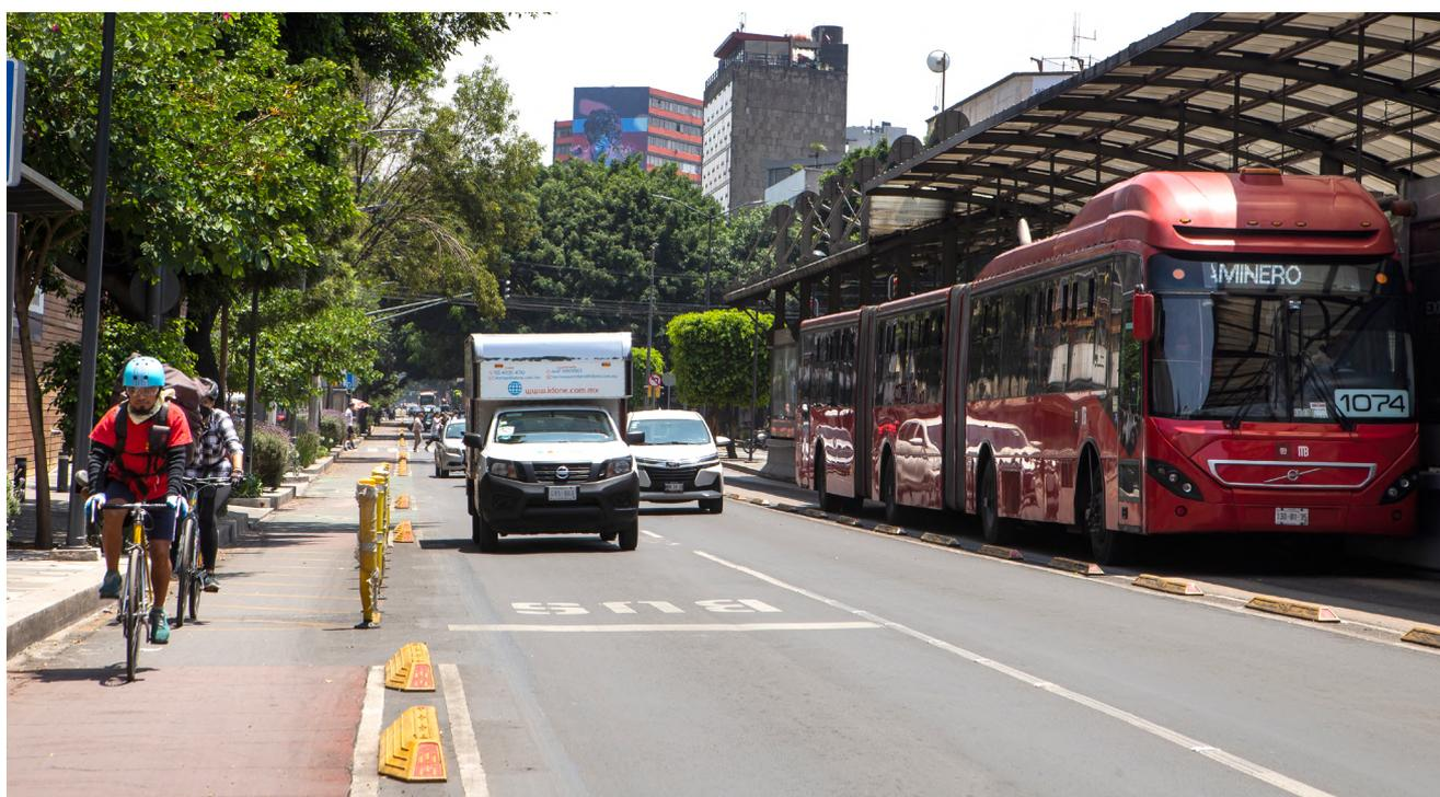
**Diretrizes de pontuação:** as ciclovias devem ser construídas no mesmo corredor ou numa rua paralela próxima e devem ter pelo menos 2 metros de largura desimpedida em cada direção. As ciclovias devem ter uma barreira física entre as bicicletas e os veículos motorizados que impeça a entrada de automóveis.
