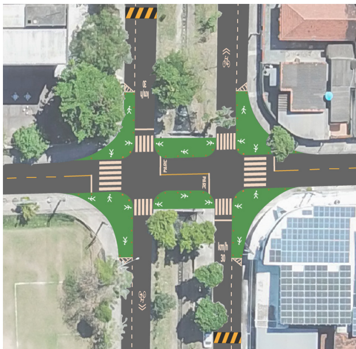
Figura 13. Boas práticas de desenho viário para raios de giro amplos e interseções.
