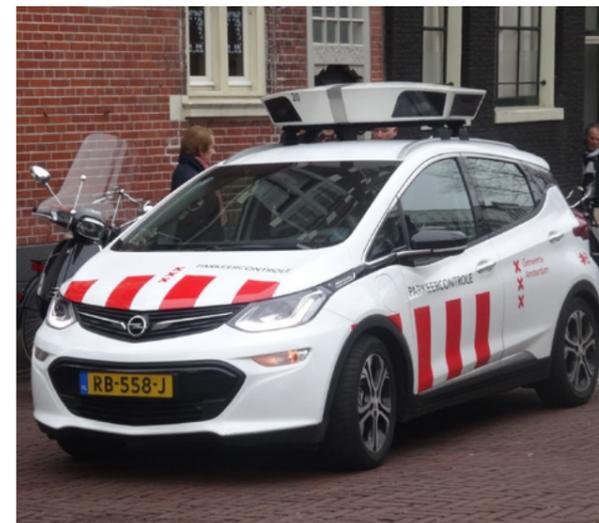
**À ESQUERDA:** Veículos elétricos são usados para fiscalizar os estacionamentos de Amsterdã, escaneando as placas e identificando os veículos que não têm uma licença ou não efetuaram o pagamento correto.
