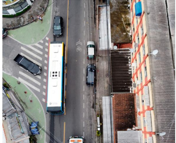
**Figuras 27 e 28.** Rua Capitão Teixeira com a Rua Cristóvão de Barros: redução do raio de curvatura, faixa de travessia de pedestres, vagas de estacionamento.
