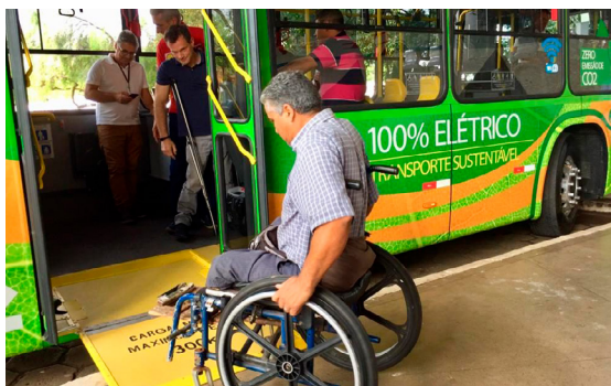
Figura 10. Os ônibus elétricos tornam as viagens mais confortáveis e seguras para os usuários, pois são mais silenciosos, estáveis, de piso baixo e com melhor desempenho térmico para passageiros e condutores. Local: Bauru. Fonte da Imagem: 94FM
