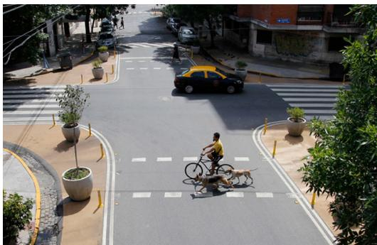
Figura 33. Esquinas com avanços de calçada para diminuição do raio de conversão dos veículos, redução da distância de travessia e aumento a visibilidade entre motoristas e pedestres, em Buenos Aires. Fonte: Prefeitura de Buenos Aires
