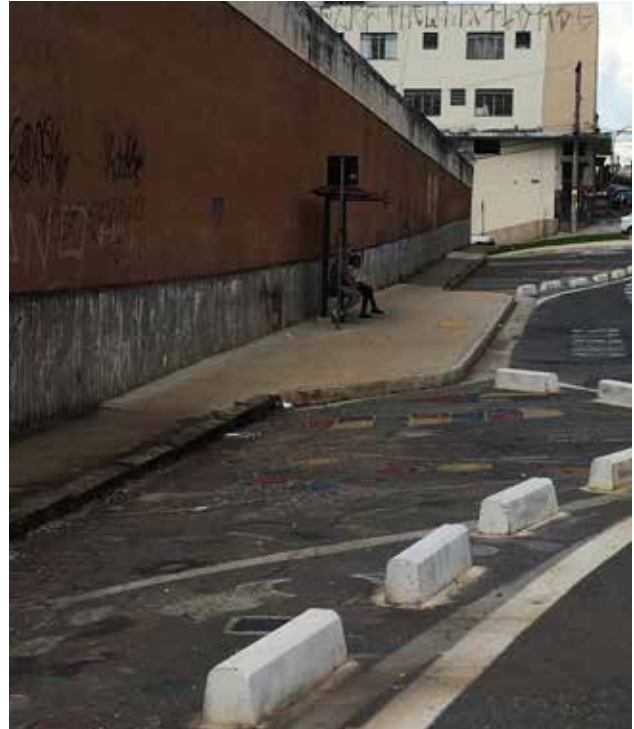
À esquerda: balizadores de concreto foram utilizados para manter a nova configuração da via após o término da ação temporária. À direita: Alargamento de calçada e cobertura para o ponto de ônibus. Imagens: BHTrans
