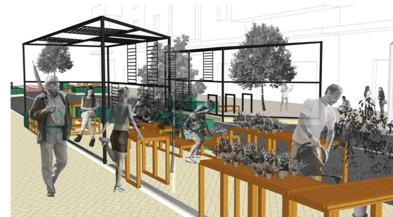
Como equipamento adicional ao mobiliário, desenvolveu-se uma estrutura fixa, a ser implantada na etapa consolidada de intervenção. Essa estrutura será metálica e poderá ser alocada em alguns dos trechos adicionais de calçada. Será possível, a partir dela, por exemplo, adicionar um anteparo para proteger o espaço da chuva, adicionar painéis para comunicação ou até utilizá-la para acrescentar mais vegetação ao espaço público.
