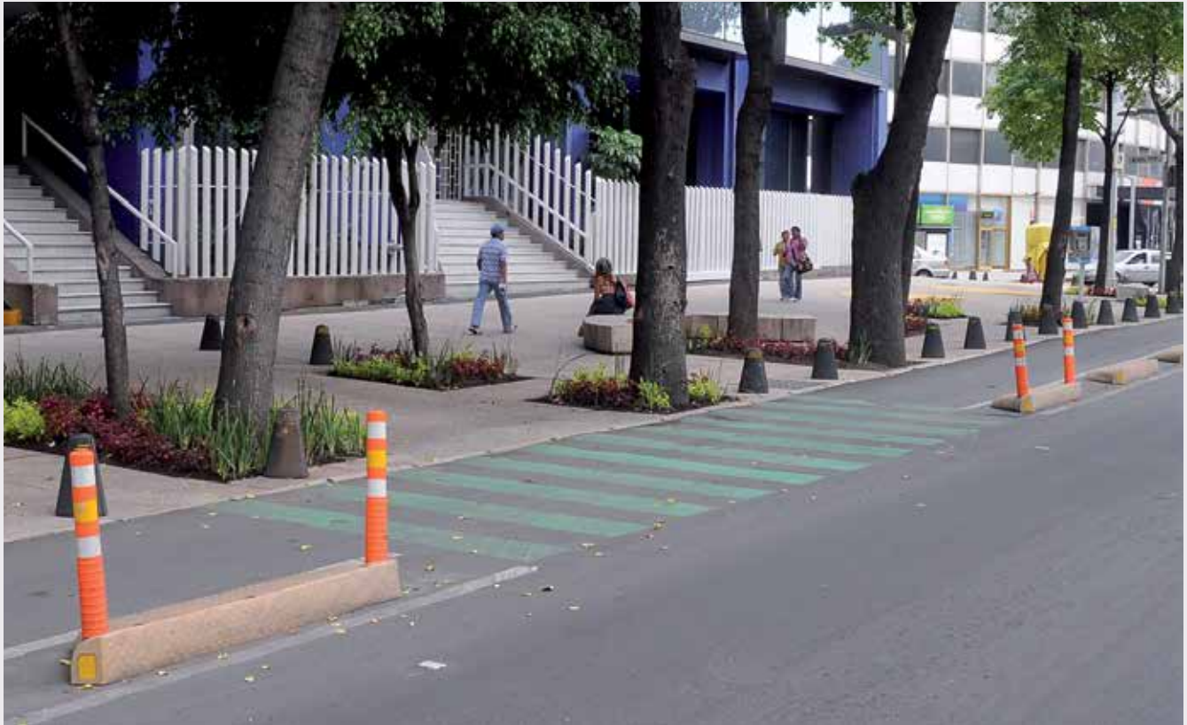
Acesso de veículos em ciclovia unidirecional na Cidade do México. Foto: ITDP México
