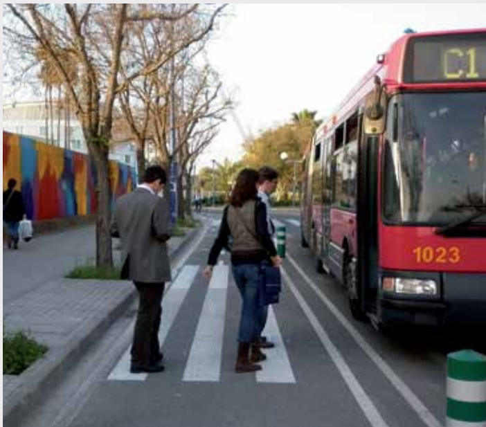
Ponto de ônibus com infraestrutura ciclovária em Copenhague, na Dinamarca. Neste caso a delimitação do espaço de circulação exclusiva de bicicletas é mantida, diferenciando-a do espaço destinado aos pedestres. Foto: ITDP México
