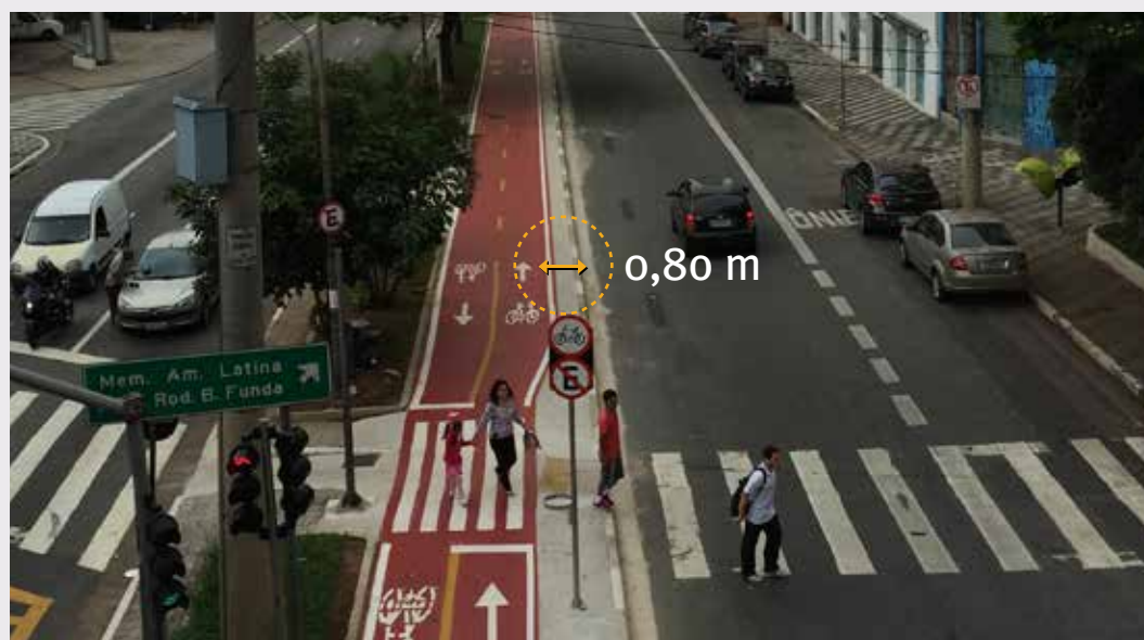
Ciclovia com faixa separadora na Rua Mario de Andrade, centro de São Paulo. A distância recomendada entre a ciclovia e o fluxo veicular é de 0,8 m. Foto: Thiago Benicchio, ITDP Brasil
