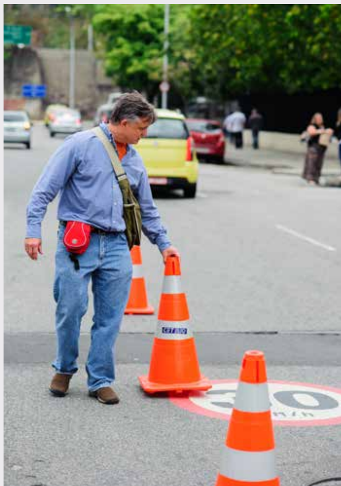
Levantamento de campo no Rio de Janeiro para observação da velocidade média dos veículos motorizados e do impacto de diferentes raios de giro no comportamento dos motoristas. Foto: Stefano Aguiar, ITDP Brasil
