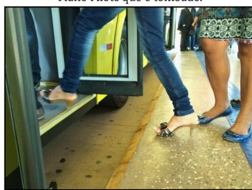
Embarque em nível dificultado pela distância de parada dos ônibus em relação à plataforma. É necessária a adequação de tachões e o melhor treinamento de motoristas ou ponte embarque.
