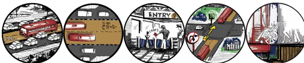
Figura 7. Elementos de um BRT Básico: Infraestrutura Segregada com Prioridade de Passagem / Alinhamento das Vias de Ônibus / Cobrança de Tarifa Fora do Ônibus / Tratamento das Interseções / Embarque por Plataforma em Nível
