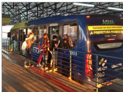
Plataforma em nível com ônibus permite o embarque de mais de um passageiro simultaneamente.
