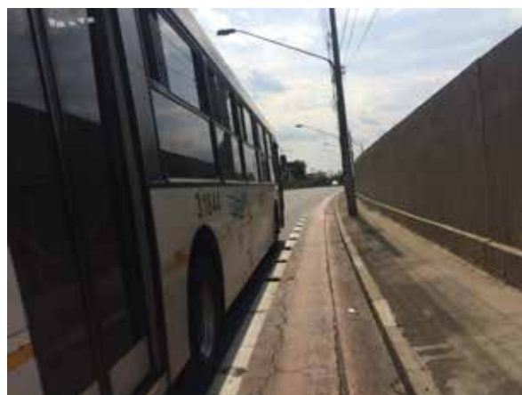
Ciclofaixa unidirecional com segregação insuficiente Av. Dr. Assis Ribeiro, Zona Leste
