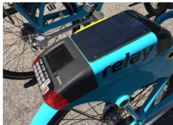
Em Atlanta, as bicicletas Relay vem equipadas com um teclado alimentado por energia solar e um leitor de cartões RFID, ambos capazes de destravar a bicicleta. Créditos: Alta Planning + Design (Flickr CC)
